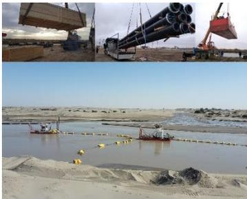
**Bildunterschrift:** Ein für den 7.000 Kilometer langen Transport zerlegtes Baggerschiff am Zielort Kerki, Turkmenistan, (oben) und im Einsatz auf dem Fluss Amudarja (unten). (Quelle: Gebrüder Weiss)
