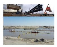
**Сопроводительная надпись:** Демонтированный земснаряд во время транспортировки длиной 7000 км (сверху) и земснаряд в работе на реке Амударья (снизу). (источник: Gebrüder Weiss)
